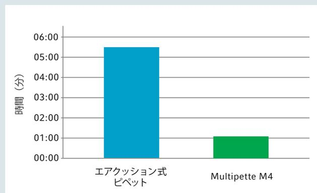
プレートへの分注に Multipette M4 を使うと、約1/5の時間で作業が完了。ルーチンワークを短時間で終えて、効率よく実験を行えます。
