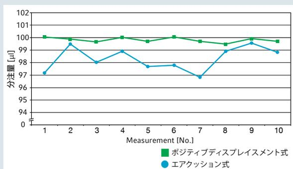
アクション式ピペット、ポジティブディスプレイメント式ピペットにて分注量を比較した結果、ポジティブディスプレイメント式ピペットはより正確に再現性良く分注できることが示されました。
